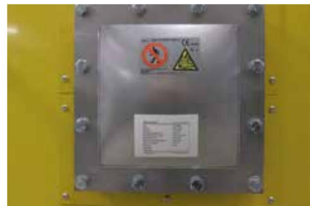
Fakultativ: Durch die Ex Schutzklappe wird im Falle einer Explosion der Druck kontrolliert abgeleitet und die Zerstörung des ganzen Aggregates vermieden. Bitte prüfen lassen!!
