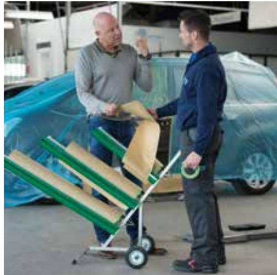
Unsere Papierabroller erleichtern Ihnen das Abdecken. Alle Abroller ziehen automatisch das Klebeband auf das Abdeckpapier mit. Die fahrbaren Abroller haben robuste Räder um auch auf Gitterrosten ein leichtes Manövrieren zu gewährleisten.
