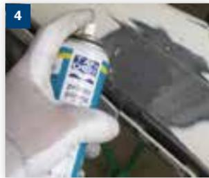
**4** Tragen Sie eine dünne Schicht Tander® Kunststoffgrundierung auf und lassen Sie diese zehn Minuten lang trocknen.
