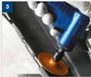
**3** Durch Modellieren und Abschleifen mit der Heißluftpistole und/oder Hamach HP 80 mit Colad-Schleifscheiben erreichen Sie eine ebene Oberfläche.
